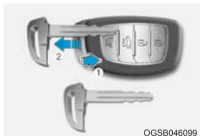
Pressione e segure o botão de liberação (1) e remova a chave mecânica (2). Insira a chave mecânica no orifício da chave da porta.
