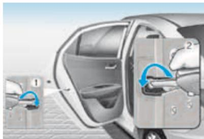
Caso não seja possível travar as portas utilizando o botão de travamento do controle remoto ou através do orifício na maçaneta externa na porta do motorista (por exemplo, quando a bateria do veículo estiver descarregada), a única maneira de travar as portas é inserindo a lâmina da chave no orifício localizado na parte interna das portas.
