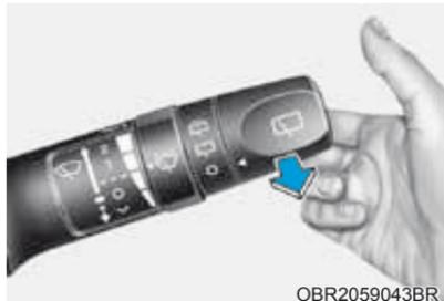
Na posição OFF (○), puxe suavemente a alavanca em sua direção para esguichar o líquido do lavador no para-brisa e acionar os limpadores por 1 a 3 ciclos.
