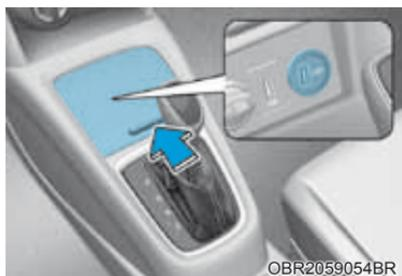
O carregador USB está localizado dentro do porta-pacote do console, entre o banco do motorista e o banco dianteiro do passageiro. Insira o cabo USB na porta USB e recarregue um telefone celular ou um tablet.
