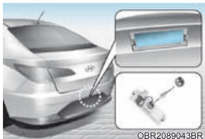
1. Usando uma chave de fenda, remova do veículo o conjunto da lâmpada apertando suavemente a lente.
