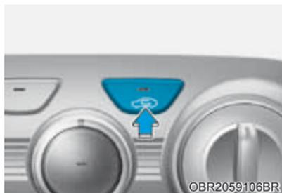
O controle de entrada de ar é usado para selecionar a posição do ar externo (fresco) ou posição de ar recirculado.
