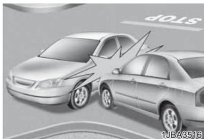
Os airbags dianteiros podem não inflar em colisões laterais, pois os ocupantes são movidos na direção da colisão. Assim, nas colisões laterais, os airbags dianteiros não proporcionariam proteção adicional ao ocupante.
