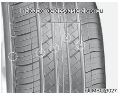
Se um pneu estiver gasto uniformemente, um indicador de desgaste aparecerá como uma faixa sólida atravessando a banda de rodagem. Isso mostra que resta menos de 1,6 mm da banda de rodagem no pneu. Substitua o pneu quando isso acontecer.
