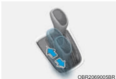
Se o veículo estiver parado ou em movimento, o modo de mudança manual é selecionado pressionando a alavanca seletora da posição “D” (Condução) no trilho manual. Para voltar ao funcionamento em “D” (Condução), pressione a alavanca seletora de volta ao trilho principal.
