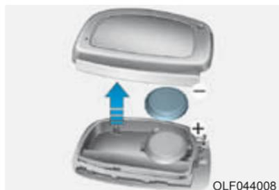
Se a chave inteligente não estiver funcionando corretamente, tente substituir a bateria por uma nova.
