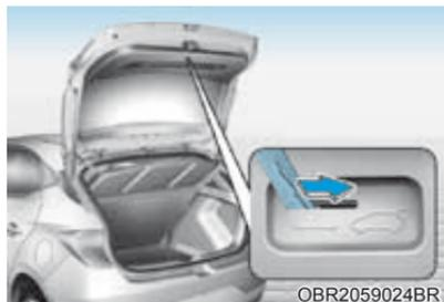
Seu veículo é equipado com uma alavanca de Liberação de Segurança de Emergência da tampa traseira localizada no fundo da tampa traseira. Quando alguém ficar preso inadvertidamente no compartimento de bagagem, a tampa traseira poderá ser aberta como segue:
