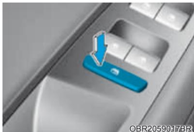
O motorista pode desabilitar os interruptores dos vidros elétricos das portas dos passageiros traseiros pressionando o botão de bloqueio dos vidros.
