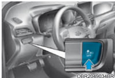
O sistema de alerta e frenagem automático estará sempre ativado. Você pode desligá-lo pressionando o botão sistema de alerta e frenagem automático OFF (Desligado) por cerca de 3 segundos.
