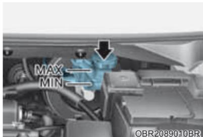
Verifique periodicamente o nível do fluido no reservatório. Ele deve estar entre as marcas "MIN" e "MAX" existentes na lateral do reservatório.
