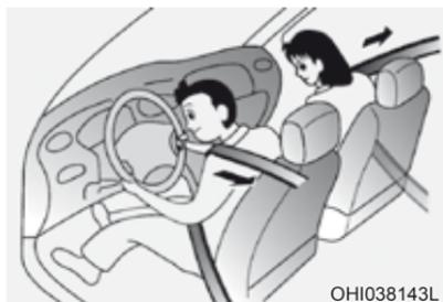
Seu veículo está equipado com pré-tensor dos cintos de segurança nos bancos do motorista e do passageiro dianteiro. A finalidade do pré-tensor é garantir que os cintos de segurança se ajustem sem folga ao corpo dos ocupantes em certas colisões frontais. Os pré-tensores dos cintos de segurança podem ser ativados, junto com os airbags, em acidentes onde a colisão frontal é suficientemente grave.
