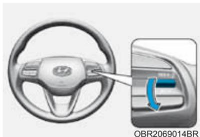
3. Pressione para baixo o interruptor (**SET-**) e libere-o. A velocidade ajustada no painel de instrumentos acenderá.
