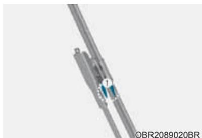
2. Comprima e segure os dois grampos da palheta do limpador (1) e remova a palheta do braço do limpador.
