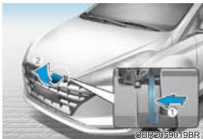
3. Vá para a frente do veículo, levante ligeiramente o capô, puxe a trava secundária (1) na parte interna do centro do capô e levante o capô (2)
