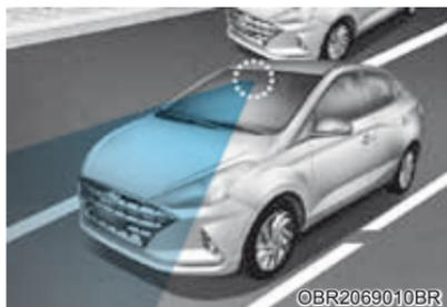
Para o Sistema de alerta e frenagem autônomo funcionar adequadamente, certifique-se que o para-brisa esteja limpo e livre de sujeira, neve, detritos, entre outros, na região da câmera.
