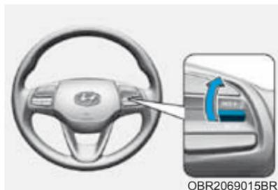
Pressione para cima o interruptor (RES+). Se a velocidade do veículo for superior a 30 km/h, o veículo retorna à velocidade pré-ajustada.
