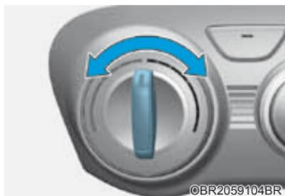
O seletor de controle de temperatura permite controlar a temperatura de ar que sai do sistema de ventilação. Gire o seletor para a posição direita para aquecimento do ar ou à esquerda para resfriar o ar.
