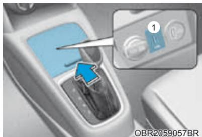
1. Conecte um dispositivo na porta USB do seu veículo (1)
