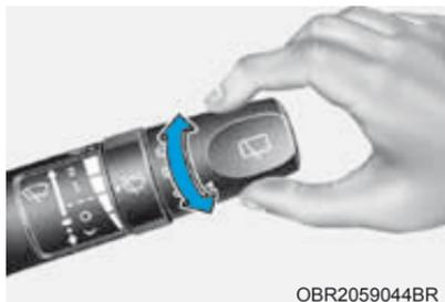
O interruptor do limpador e lavador do vidro traseiro está localizado na extremidade da alavanca do interruptor do limpador e lavador
