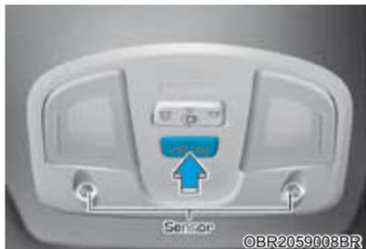
O sensor de intrusão/inclinação detecta movimento no interior do veículo e inclinação do veículo após o travamento.
