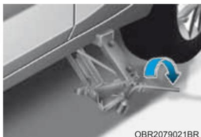
8. Encaixe a alavanca no macaco e gire-a no sentido horário, levantando o veículo até que o pneu desencoste do solo. Esta medição é aproximadamente 30 mm. Antes de remover as porcas das rodas, certifique-se o veículo esteja estável e não exista a possibilidade de movimentação ou deslizamento.
