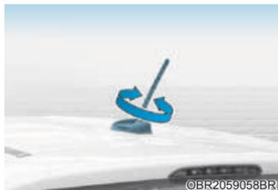
Seu veículo usa uma antena de teto para receber sinais de emissoras AM e FM. Esta antena é do tipo removível. Para remover a antena de teto gire-a no sentido anti-horário. Para instalar a antena de teto gire-a no sentido horário.
