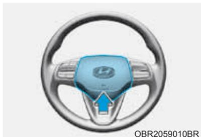
Para acionar a buzina, pressione a área indicada pelo símbolo da buzina no volante de direção (veja a ilustração). A buzina só funcionará quando esta área for pressionada.
