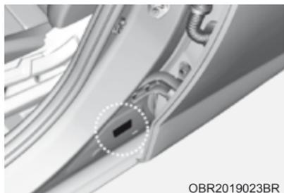
A etiqueta de identificação do veículo fixada na coluna central do lado do motorista (ou do passageiro dianteiro) mostra o número de identificação do veículo (VIN).
