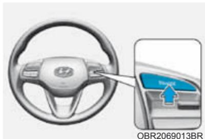
1. Pressione o botão MODE para ligar o sistema. O indicador do limite de velocidade no painel de instrumentos acenderá.
