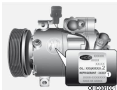
A etiqueta do compressor do ar condicionado informa qual tipo de compressor equipa seu veículo, assim como modelo, número do fabricante, número de série, gás refrigerante (1) e óleo lubrificante (2).
