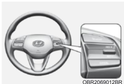
MODE: Muda o modo entre sistema de controle de cruzeiro e sistema de controle do limite de velocidade.
