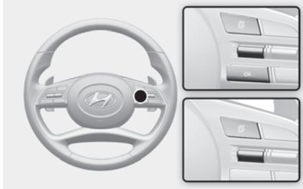
Os modos de exibição do painel podem ser alterados usando os botões de controle.
