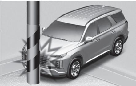
Os airbags podem não inflar se o veículo colidir com objetos como postes ou árvores, onde o ponto de impacto está concentrado e a energia da colisão é absorvida pela estrutura do veículo.
