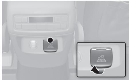
O inversor de CA fornece 220 volts (200 watts) de energia elétrica para operar acessórios ou equipamentos elétricos.
