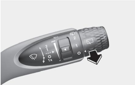
Na posição DESLIGADO, puxe a alavanca suavemente na sua direção para borrifar o fluido de lavagem no para-brisa e acionar os limpadores por 1 a 3 ciclos. O funcionamento do spray e do limpador continuará até você soltar a alavanca. Se o lavador não funcionar, pode ser necessário adicionar fluido de lavagem ao reservatório do fluido de lavagem.
