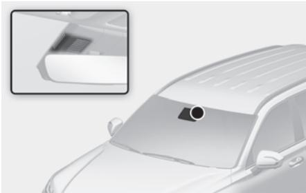
O desembaçamento automático reduz a probabilidade de embaçamento no interior do para-brisa, detectando automaticamente a umidade no interior do para-brisa.
