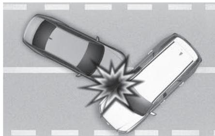
Nas colisões angulares, a força do impacto pode levar os ocupantes a uma direção na qual os airbags não poderiam oferecer nenhum benefício adicional e, portanto, os sensores podem não acionar nenhum airbag.
