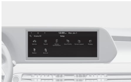
As Configurações do veículo no sistema de infoentretenimento fornece opções ao usuário para diversas configurações, incluindo recursos de travamento/destravamento de porta, recursos de conveniência, configurações de assistência ao condutor, etc.
