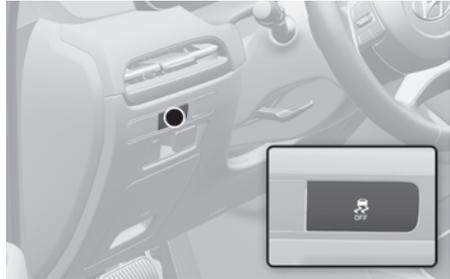
O sistema de Controle de estabilidade eletrônico (ESC) ajuda a estabilizar o veículo durante manobras em curva.
