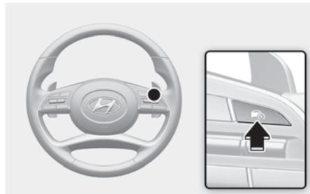
1. Mantenha pressionado o botão Assistente de condução (Ⓢ) na velocidade desejada. O indicador de Limite de velocidade (Ⓢ)LIMIT aparecerá no painel de instrumentos.
