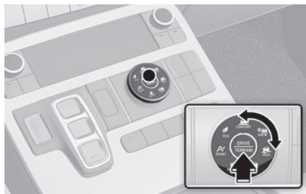
Pressione o botão de CONDUÇÃO/TERRENO para mudar do modo de condução para o modo Multiterreno. Depois de pressionar o botão, gire-o em até 4 segundos para selecionar NEVE, LAMA ou AREIA.
