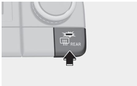
O desembaçador aquece o vidro para remover gelo, neblina e gelo fino do interior e exterior do vidro traseiro, enquanto o veículo está em funcionamento.
