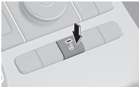
Com o botão Start/Stop (Partida/Parada) do motor na posição ON ou o motor em funcionamento, pressione o botão do aquecedor do volante para aquecer o volante. O indicador no botão acende.
