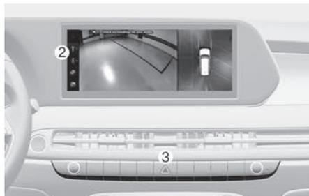
A visão dianteira aparece na tela quando a marcha está em N (ponto morto) ou D (condução) para auxiliar no estacionamento. Utilizando o botão de visualização (2), você pode selecionar vista superior, vista frontal, vista lateral.
