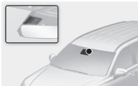
O sensor de chuva localizado na extremidade superior do para-brisa detecta a quantidade de chuva e controla o ciclo de limpeza para o intervalo adequado.
