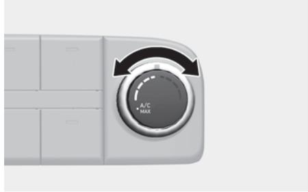
A temperatura do ar fornecido pode ser ajustada para a temperatura desejada pressionando o botão de controle de temperatura.
