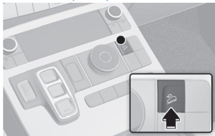
O Controle de freios em descidas ajuda o condutor a descer uma colina íngreme sem ter de pressionar o pedal do freio.
