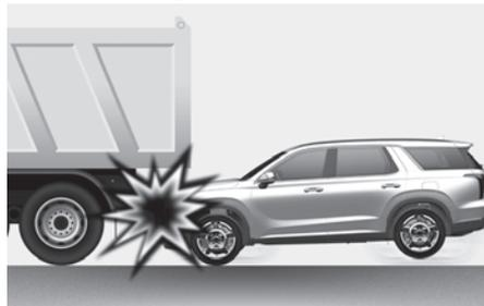
Um pouco antes do impacto, os condutores geralmente freiam com força. Essa frenagem brusca abaixa a parte dianteira do veículo, fazendo com que ele “passe” sob um veículo com maior distância ao solo. Os airbags podem não inflar nesta situação de “passar por baixo de um veículo” porque as forças de desaceleração que são detectadas pelos sensores podem ser significativamente reduzidas por tais colisões.
