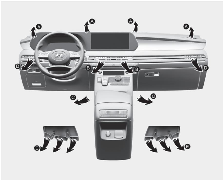
O botão de modo de seleção controla a direção do fluxo de ar pelo sistema de ventilação.
