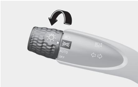
A luz de posição, a luz da placa e a lâmpada do painel de instrumentos acendem.
