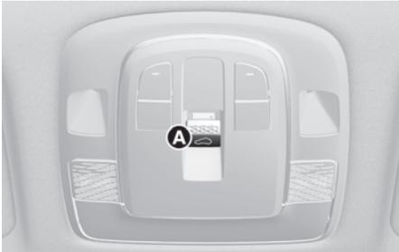
O para-sol abre-se automaticamente quando o vidro do teto solar é aberto empurrando o interruptor do teto solar (A) para trás, mas o para-sol não se fecha automaticamente quando o vidro do teto solar é fechado. Além disso, apenas o para-sol não pode ser fechado quando o vidro do teto solar é aberto.
