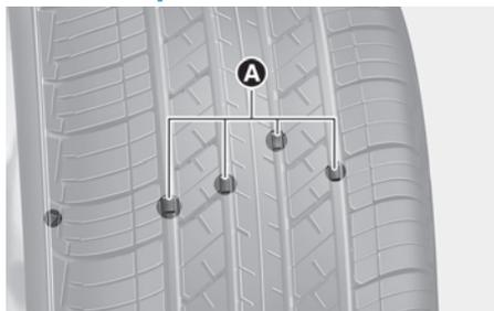
[A] : Indicador de desgaste da banda de rodagem
