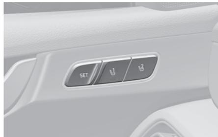
O Sistema de memória integrada para o assento do motorista é fornecido para armazenar e recuperar as seguintes configurações de memória com uma simples operação de botão.
