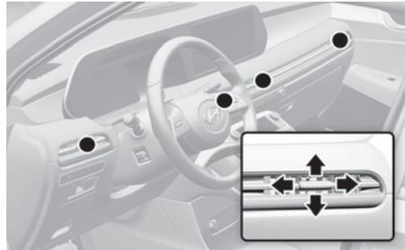
O fluxo das passagens de ar do painel de instrumentos pode ser direcionado para cima/baixo ou para a esquerda/direita usando a alavanca de ajuste das passagens de ar.
