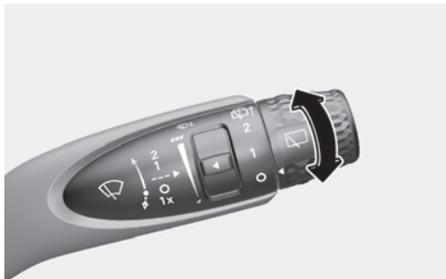
O botão do limpador e lavador do vidro traseiro está localizado na extremidade da alavanca do botão do limpador e do lavador. Gire o interruptor para a posição desejada para acionar o limpador e o lavador traseiro.
