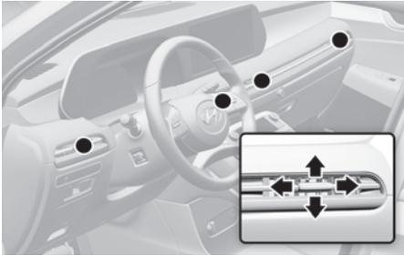
O fluxo das passagens de ar do painel de instrumentos pode ser direcionado para cima/baixo ou para a esquerda/direita usando a alavanca de ajuste das passagens de ar.
