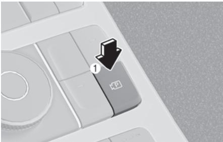
Pressione o botão Parking/View (estacionamento/visão) (1) enquanto a marcha estiver em P (estacionamento), D (condução) ou N (ponto-morto) para ligar o Monitor de visão traseira.
