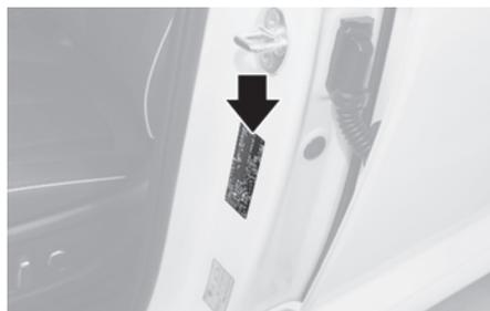
A etiqueta de certificação do veículo fixada na coluna central do lado do condutor (ou do passageiro dianteiro) contém o número de identificação do veículo (NIV).
