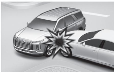
Os airbags dianteiros podem não inflar nas colisões com impacto lateral porque os ocupantes se movem na direção da colisão, e, portanto, nos impactos laterais, o acionamento do airbag dianteiro não ofereceria proteção adicional ao ocupante.
