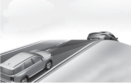
Ao conduzir em subidas ou descidas, o Controle de velocidade constante inteligente poderá não detectar um veículo em movimento em sua faixa e fazer com que seu veículo acelere até a velocidade definida. Além disso, a velocidade do veículo diminuirá rapidamente quando o veículo à frente for detectado de maneira repentina.
