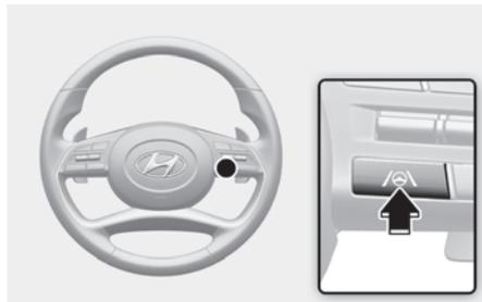
Com o veículo ligado, pressione rapidamente o botão Lane Driving Assist (Assistente de direção na faixa) localizado no volante para ativar o Assistente de acompanhamento de faixa. A luz indicadora cinza ou verde (🚗) aparecerá no painel de instrumentos.
