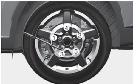
5. Afrouxe as porcas da roda no sentido anti-horário, uma volta cada uma, mas não retire nenhuma porca da roda até que o pneu tenha sido levantado do chão.
