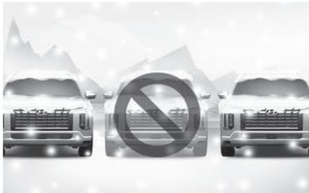
A neve pode interferir na operação do sensor ultrassônico ou o Assistente de estacionamento inteligente remoto pode ser cancelado se a estrada estiver escorregadia durante o estacionamento.
