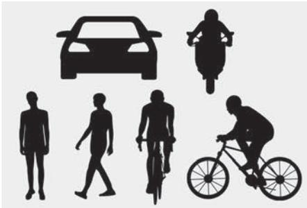
A ilustração acima mostra a imagem que a câmera de visão dianteira e o radar dianteiro são capazes de detectar como veículo, veículo motorizado de duas rodas, pedestre e ciclista.
