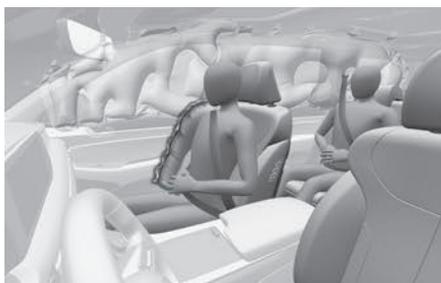
O seu veículo está equipado com um airbag lateral em todos os assentos da frente. A finalidade do airbag é fornecer uma proteção adicional ao veículo além daquela oferecida pelo cinto de segurança.
