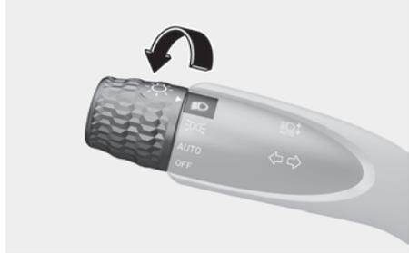
O farol, a luz de posição, a luz da placa e a lâmpada do painel de instrumentos acendem.
