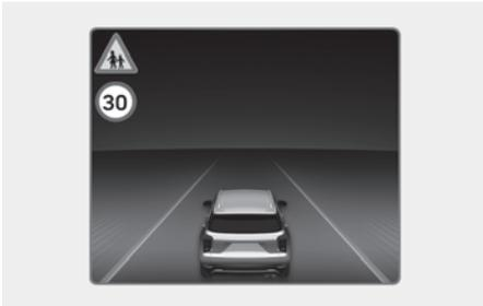
As informações de limite de velocidade são exibidas no painel de instrumentos.
