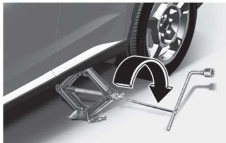
7. Insira a chave do macaco no macaco e gire no sentido horário, levantando o veículo até que o pneu se afaste do chão. Esta medição é de aproximadamente 30 mm (1,2 pol.). Antes de retirar as porcas das rodas, verifique se o veículo está estável e se não há chance de movimento ou deslizamento.
