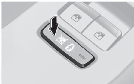
O condutor pode desativar os interruptores de vidro elétrico nas portas dos passageiros do banco traseiro pressionando o botão de trava do vidro elétrico.
