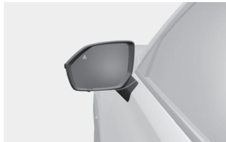
Para avisar o condutor de que um veículo foi detectado, a luz de alerta no espelho retrovisor externo acende e o head-up display (se equipado) acendem.
