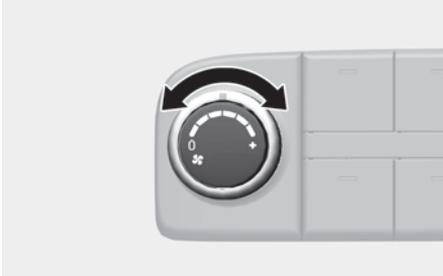
Gire o botão para a direita para aumentar a velocidade do ventilador e do fluxo do ar. Gire o botão para a esquerda para diminuir a velocidade do ventilador e do fluxo do ar.
