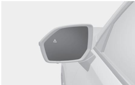
Seu veículo está equipado com espelhos retrovisores externos dos lados direito e esquerdo. Os espelhos podem ser ajustados com o interruptor de controle de ajuste dos espelhos. Os espelhos retrovisores externos podem ser recolhidos para ajudar a evitar danos durante a lavagem automática do veículo ou ao passar por uma rua estreita.
